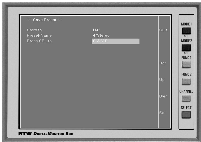
Bild D 3-3: Das Menü „Save Preset“ des DigitalMonitor 8ch 10689
